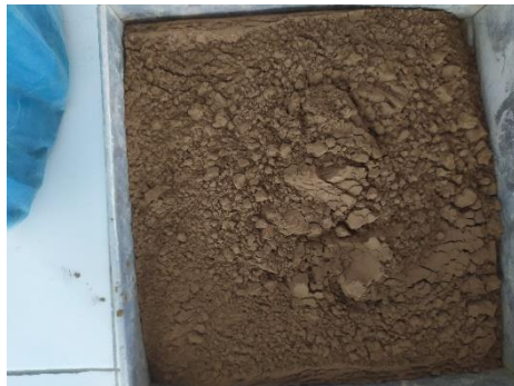
Gambar 2. Abu Terbang PLTU Tenayan Raya
