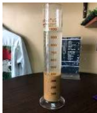
Gambar 2. Hasil pengujian kadar lumpur pada pasir (Data Lapangan, 2021)
